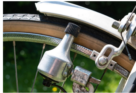
Abbildung 1: Links: Aufbau eines Fahrrads. Rechts: Foto eines alten Fahrraddynamos (Quelle: Focus online)
