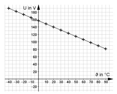
richtige Werte für Maximal- und Minimalspannung:  $U_{max}=(140+50,4)\,\mathrm{V}=190,4\,\mathrm{V};$   $U_{min}=(140-58,8)\,\mathrm{V}=81,2\,\mathrm{V}$
